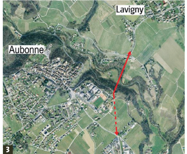
1) La variante Hans Niderhauser, soit le contournement est par le vallon de l'Aubonne avec galerie (traitillé) puis route. 2) La variante Jean Maurer, soit un évitement court avec tunnel et galerie. 3) La variante Fabrice Meylan, soit un contournement est par la création d'un pont sur l'Aubonne avec un début en galerie (traitillé). SERVICES TECHNIQUES/AUBONNE/CHRYSOULA BOUACHRINE
