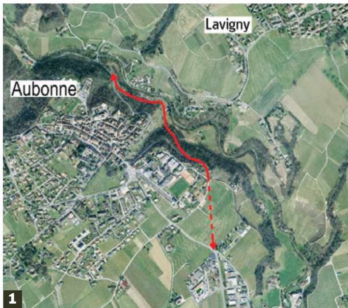
1) La variante Hans Niderhauser, soit le contournement est par le vallon de l'Aubonne avec galerie (traitillé) puis route. 2) La variante Jean Maurer, soit un évitement court avec tunnel et galerie. 3) La variante Fabrice Meylan, soit un contournement est par la création d'un pont sur l'Aubonne avec un début en galerie (traitillé). SERVICES TECHNIQUES/AUBONNE/CHRYSOULA BOUACHRINE
